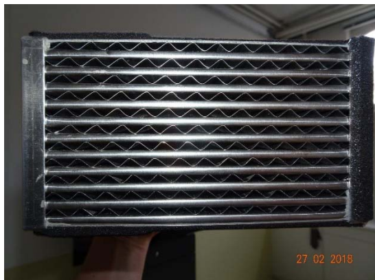
Abbildung 224: WNG ID 1010: Wärmetauscher
