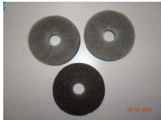
Abbildung 212: WNG ID 920: Zuluftfilter, Rückseite
