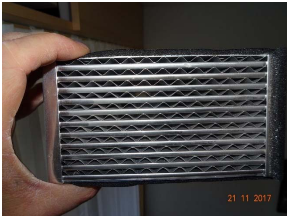
Abbildung 34: WNG ID 120: Wärmetauscher
