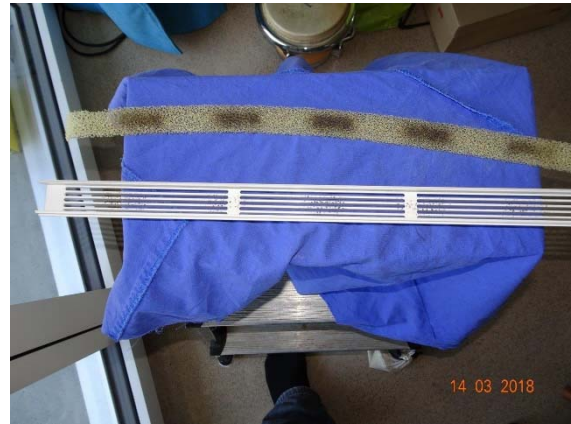
Abbildung 186: WNG ID 810: Zuluftfilter, Rückseite
