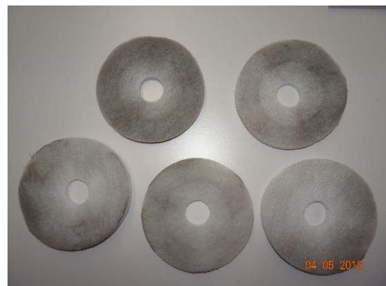
Abbildung 207: WNG ID 910: Zuluftfilter, Rückseite
