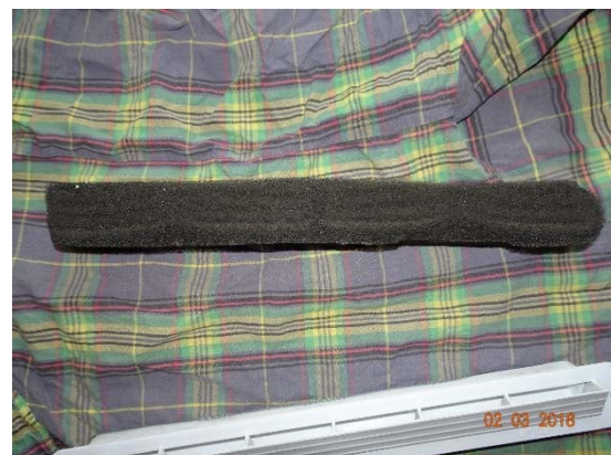
Abbildung 175: WNG ID 730: Zuluftfilter
