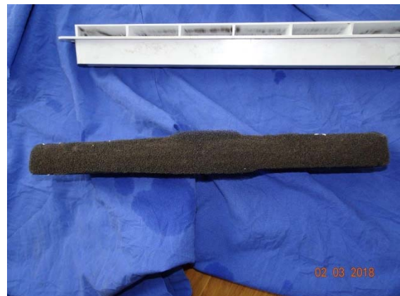
Abbildung 166: WNG ID 730: Zuluftfilter
