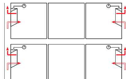
Aerazione con finestre ad apertura automatizzata
