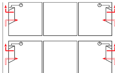
Aération automatique par les fenêtres
